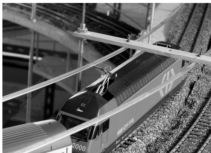
Detail der Befestigung des Schienenprofils auf der Oberseite des Querträgers.
